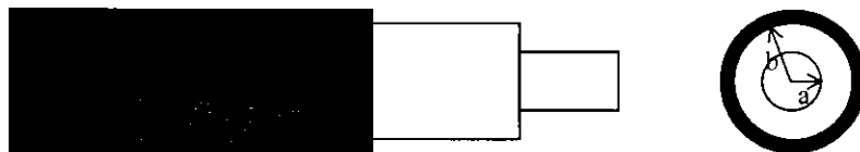
Fig. 2.6 – Vista lateral e frontal de uma fibra óptica.
