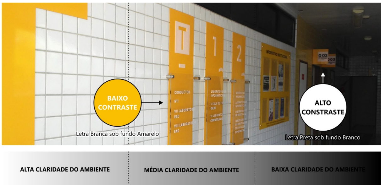
Figura 42 - Análise do contraste cor da letra observada no corredor com iluminação natural.
