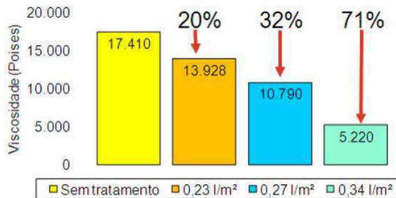
Figura 4 - Efeito do RejuvaSeal na viscosidade do ligante asfáltico
