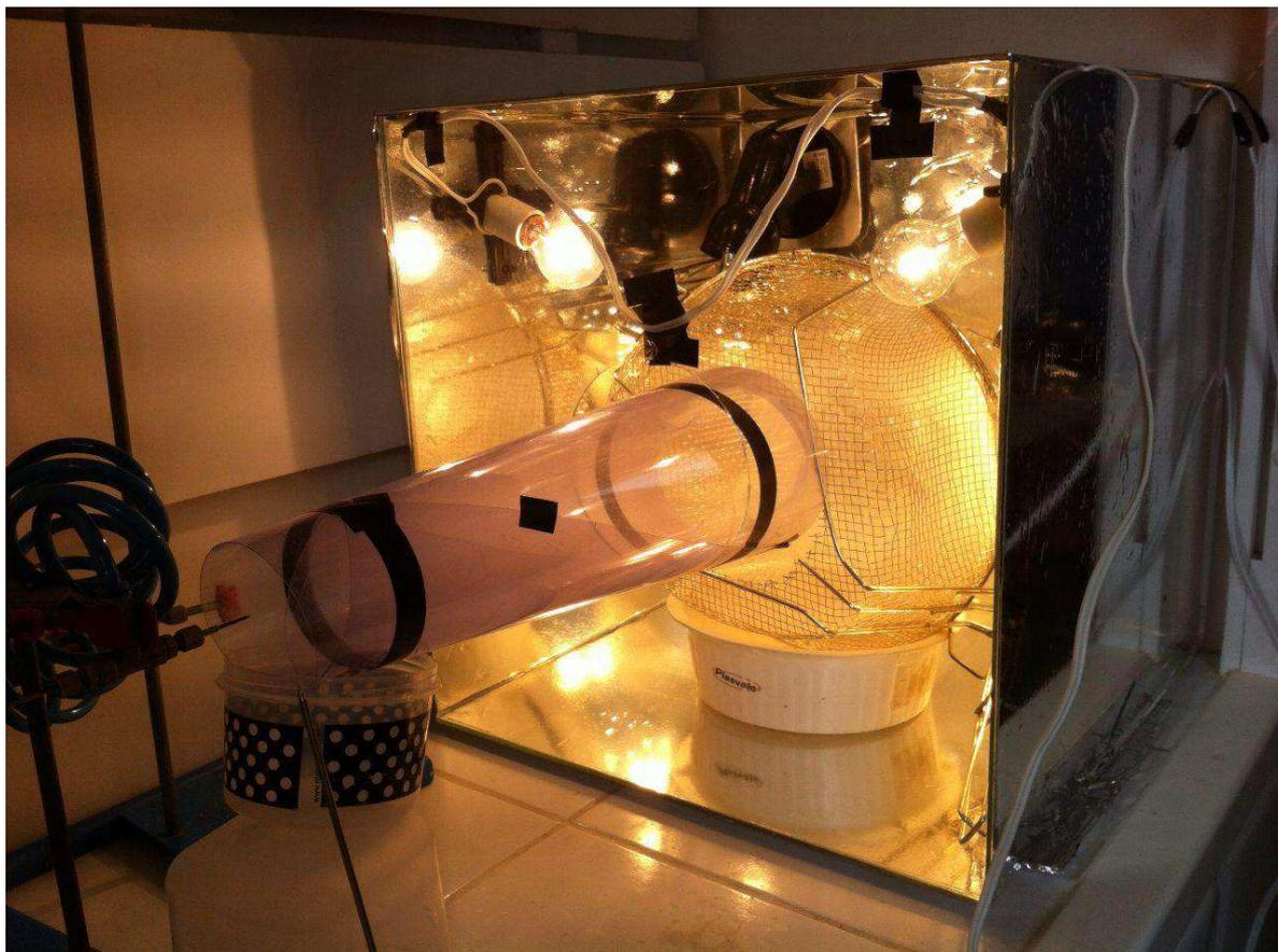
Figura 7 - Aparato de fiação evidenciando a caixa e a gaiola de fiação
