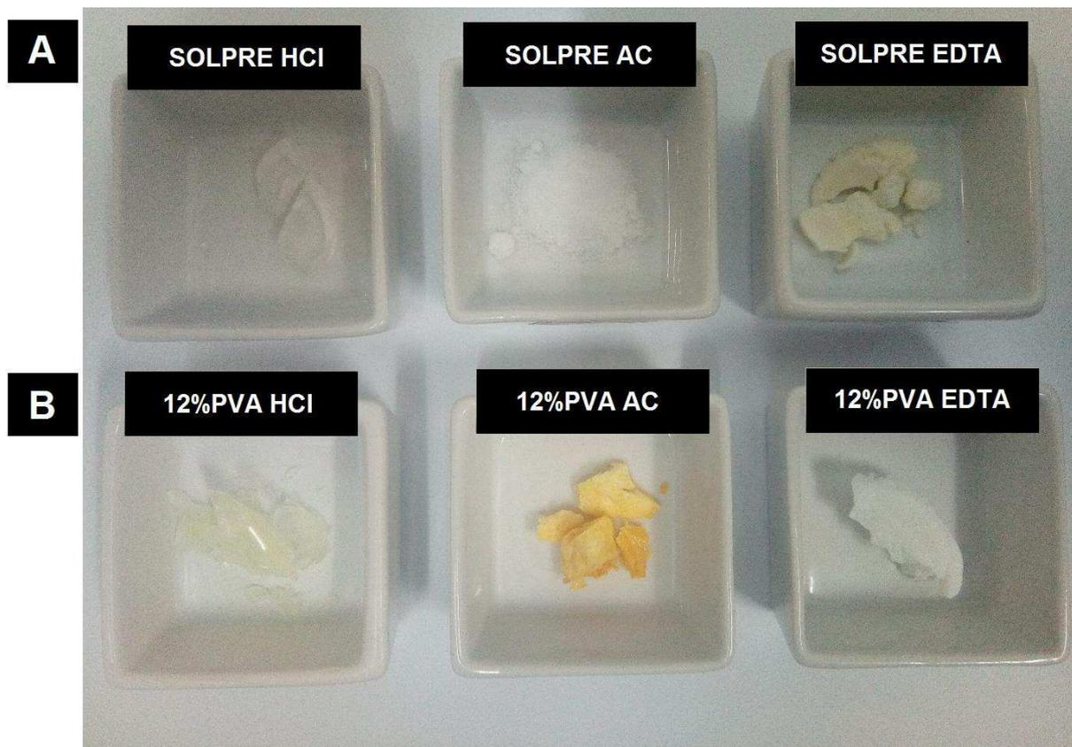
Figura 10 - Imagens dos sois géis para a composição 45S5 depois da secagem. (A) Sois géis sem adição de polímero e (B) sois géis com adição de polímero.
