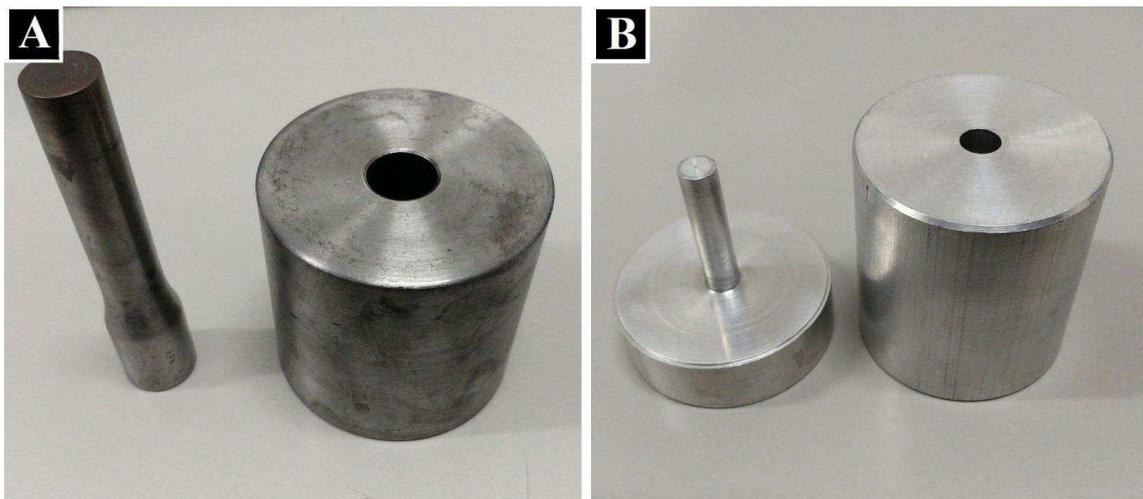
Figura 8 - Moldes utilizados para a preparação dos scaffolds cilíndricos
