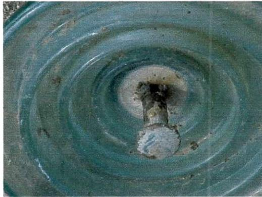
Figura 22 – Oxidação em isolador de vidro.
