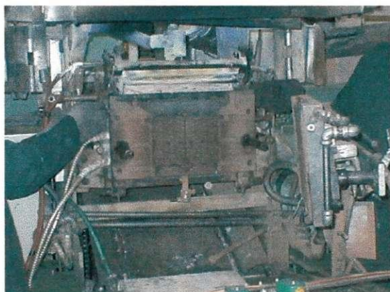
Fig 10 – Molde de Grade (a) Molde acoplado à fundidora (b) Face Móvel do Molde
