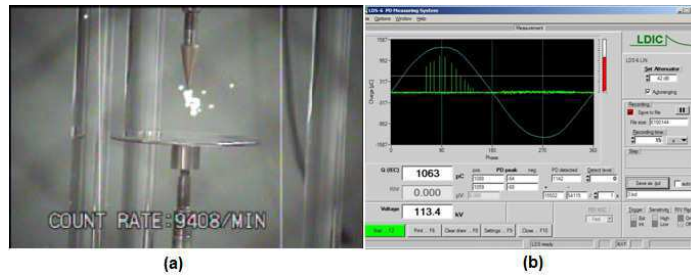
Figura 21 – Eletrodo Ponta Fina – 17 kV; 5,0cm; 5 min. (a) Imagem Daycor, (b) LDIC.
