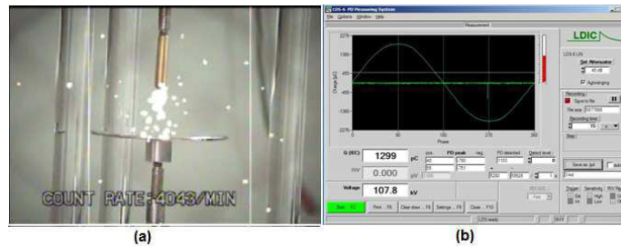
Figura 39 – Eletrodo Ponta Arredondada – 25 kV; 5,0 cm; 5 min. (a) Imagem Daycor, (b) LDIC.
