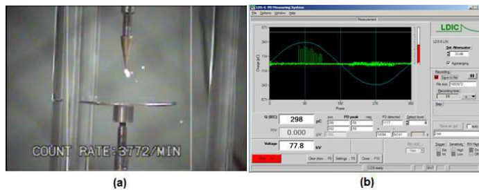
Figura 18 – Eletrodo Ponta Fina – 12 kV; 5,0cm; 5 min. (a) Imagem Daycor, (b) LDIC.
