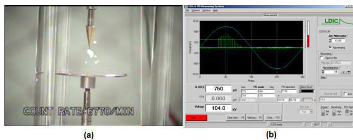
Figura 20 – Eletrodo Ponta Fina – 16 kV; 5,0cm; 5 min. (a) Imagem Daycor, (b) LDIC.
