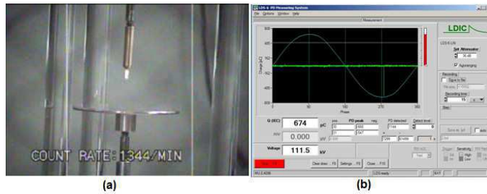
Figura 41 – Eletrodo Ponta Arredondada – 26 kV; 5,5 cm; 5 min. (a) Imagem Daycor, (b) LDIC.
