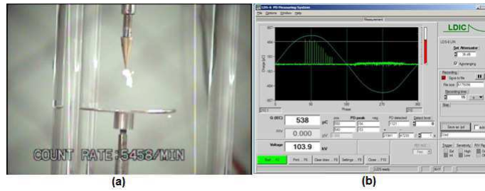
Figura 26 – Eletrodo Ponta Fina – 16 kV; 5,5cm; 5 min. (a) Imagem Daycor, (b) LDIC.
