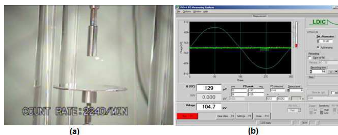
Figura 46 – Eletrodo Ponta Plana – 24 kV; 6,0 cm; 5 min. (a) Imagem Daycor, (b) LDIC.
