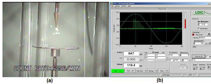
Figura 34 – Eletrodo Ponta Fina – 18 kV; 6,0 cm; 5 min. (a) Imagem Daycor, (b) LDIC.
