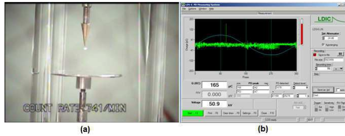
Figura 22 – Eletrodo Ponta Fina – 8 kV; 5,5cm; 5 min. (a) Imagem Daycor, (b) LDIC.
