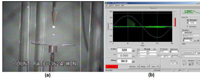
Figura 32 – Eletrodo Ponta Fina – 14 kV; 6,0 cm; 5 min. (a) Imagem Daycor, (b) LDIC.
