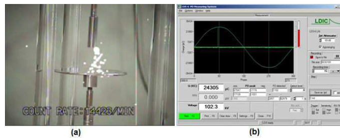
Figura 45 – Eletrodo Ponta Plana – 24 kV; 5,0 cm; 5 min. (a) Imagem Daycor, (b) LDIC.
