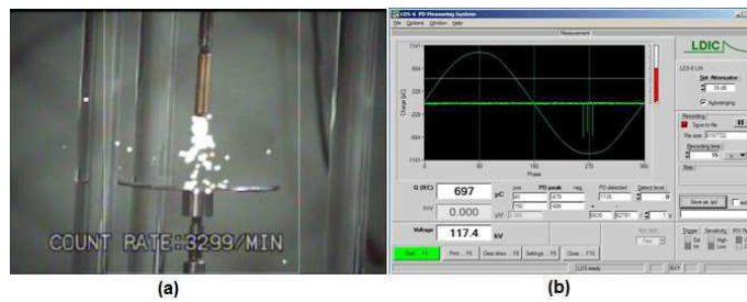
Figura 43 – Eletrodo Ponta Arredondada – 27 kV; 6,0 cm; 5 min. (a) Imagem Daycor, (b) LDIC.
