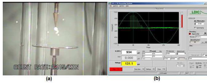
Figura 36 – Eletrodo Ponta Fina – 22 kV; 6,0 cm; 5 min. (a) Imagem Daycor, (b) LDIC.
