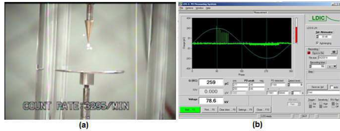
Figura 24 – Eletrodo Ponta Fina – 12 kV; 5,5cm; 5 min. (a) Imagem Daycor, (b) LDIC.
