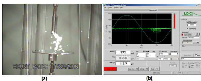
Figura 48 – Eletrodo Ponta Plana – 27 kV; 6,0 cm; 5 min. (a) Imagem Daycor, (b) LDIC.
