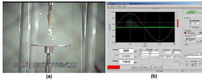
Figura 27 – Eletrodo Ponta Fina – 18 kV; 5,5cm; 5 min. (a) Imagem Daycor, (b) LDIC.
