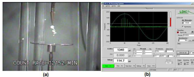
Figura 35 – Eletrodo Ponta Fina – 20 kV; 6,0 cm; 5 min. (a) Imagem Daycor, (b) LDIC.
