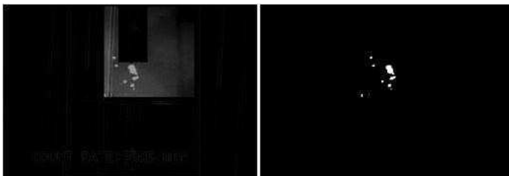
Figura 5.1: Eletrodo ponta fina com gap de 50 mm submetido a uma tensão de 17 kV. a) Imagem escurecida e b) imagem binária
