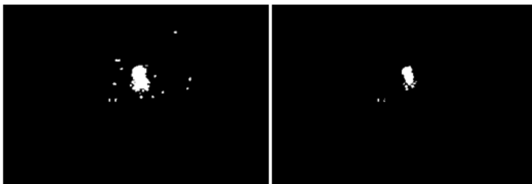
Figura 5.2: Eletrodo ponta fina com gap de 50 mm submetido a uma tensão de 17 kV.
