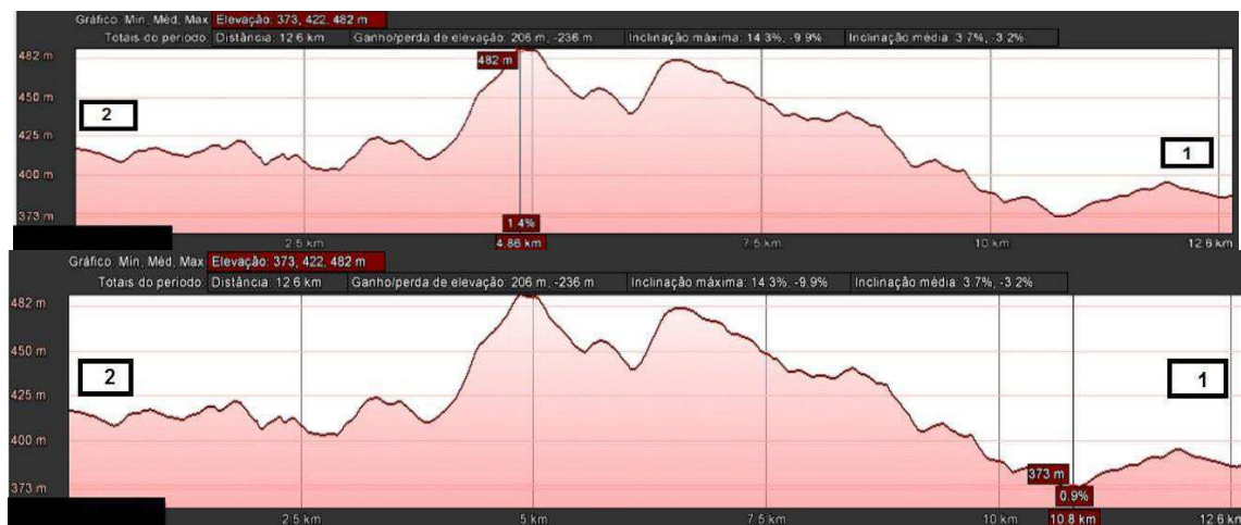
Figura 23 - Perfil topográfico da rodovia PB-400, trecho 361.
