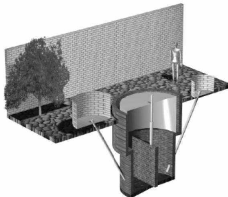
Figura 3. Estrutura de um biodigestor do tipo Indiano
