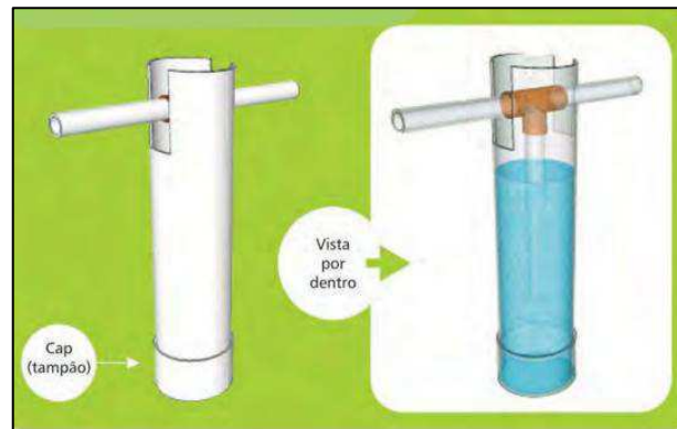
Figura 25. Modelo do dreno de biogás proposto
