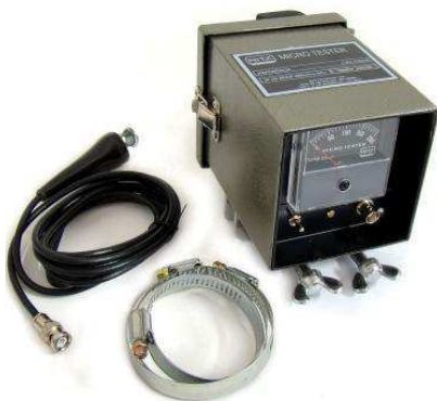
Figura 12 - Fotografia do Microamperímetro da Marca Ritz do Brasil.
