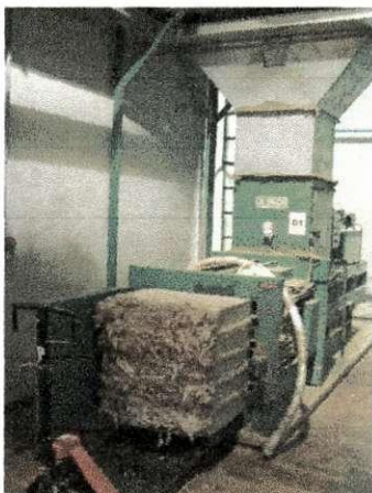
Fig. 27 - Prensa produzindo fardo material não reciclado
