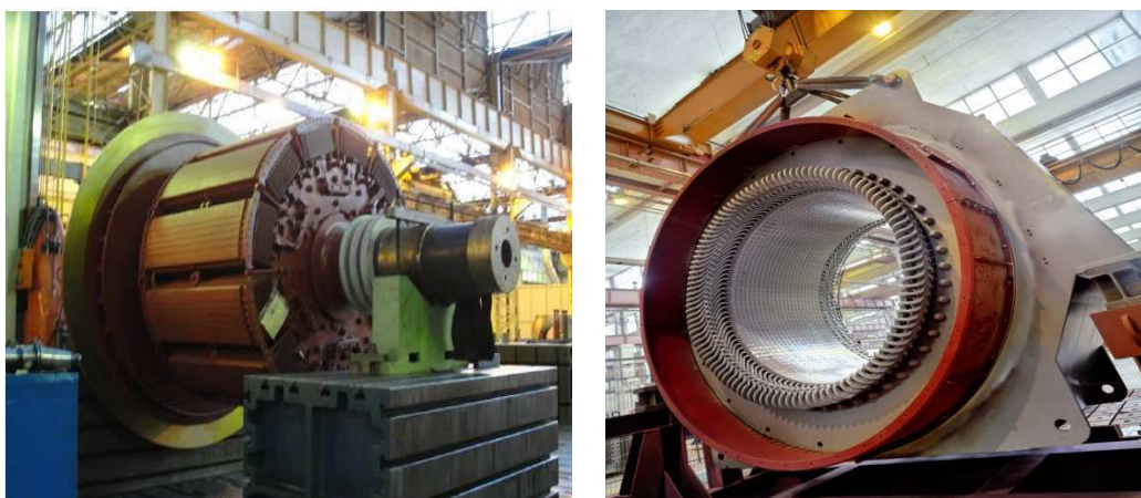
Figura 20 – Rotor e estator PCH Queluz – SP.
