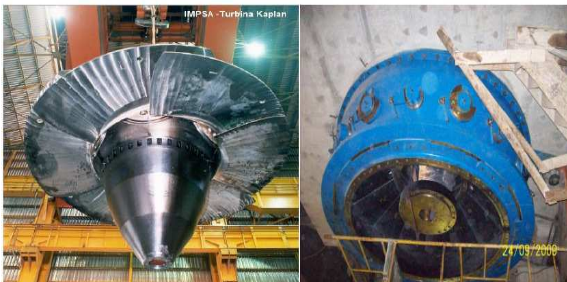
Figura 6 - Turbina Kaplan à esquerda e distribuidor à direita.
