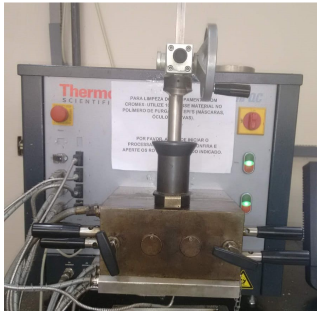
Figura 2.11: Misturador interno de laboratório Haake Rheomix, com capacidade para processar bateladas de 50 e 500 g (dependendo do modelo e tipo de rotores).
