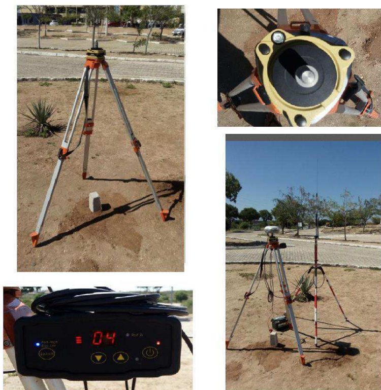
Figura 37 - Receptor CHC X900 trabalhando como base.
