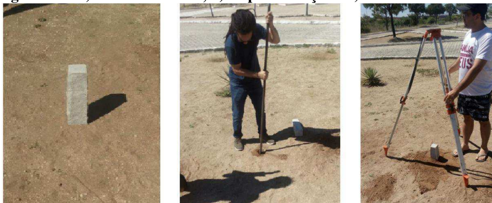
Figura 36 – a) Marco utilizado, b) Implementação e c) nivelamento da base.
