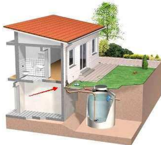
Figura 17. Sistema de captação e armazenamento com filtro na linha de fluxo.
