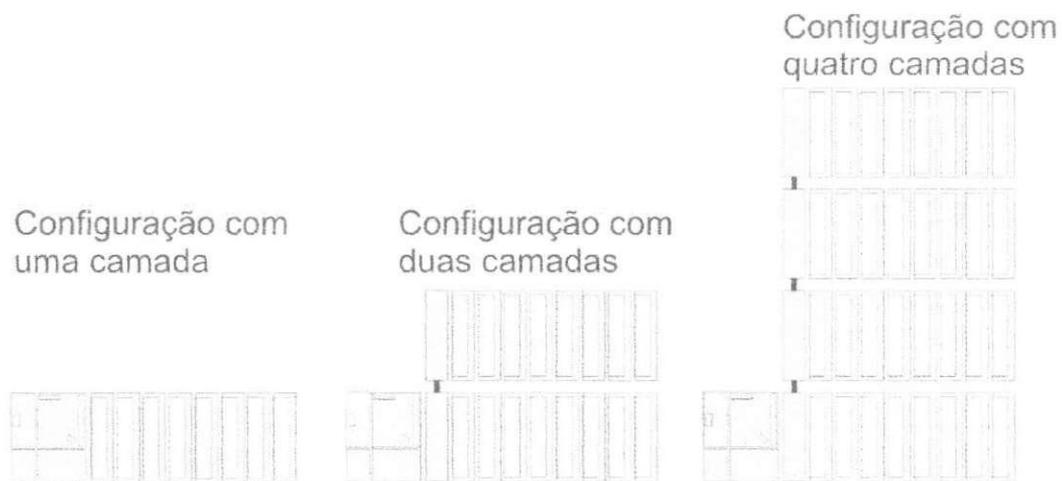
**Figura 1.3** mostra três tipos de configuração: com uma, duas e quatro camadas. Note que na configuração com mais de uma camada é necessário o uso de módulos de interface em cada rack.
