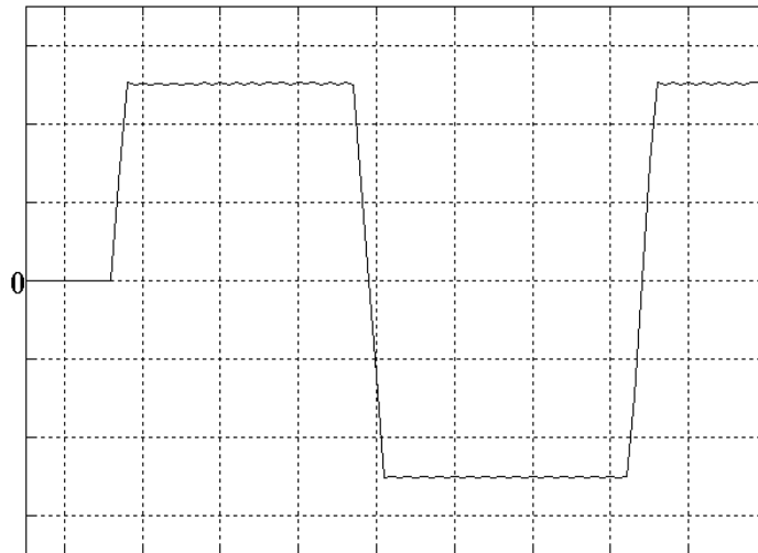
Fig. 4.29. Experimental. Velocidade do rotor (300rpm/div) durante a partida e inversão de velocidade do motor de 0, 700, -700 rpm. Hor: 160 ms/div.
