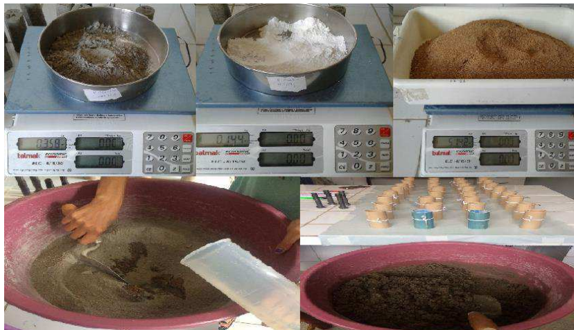
Figura 3 – Confecção dos corpos de prova.
