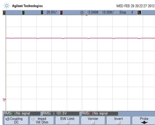
**Figura 9.4** – Tensão do barramento  $cc$  do filtro universal padrão para  $\theta_{v_l} = -20^\circ$ .
