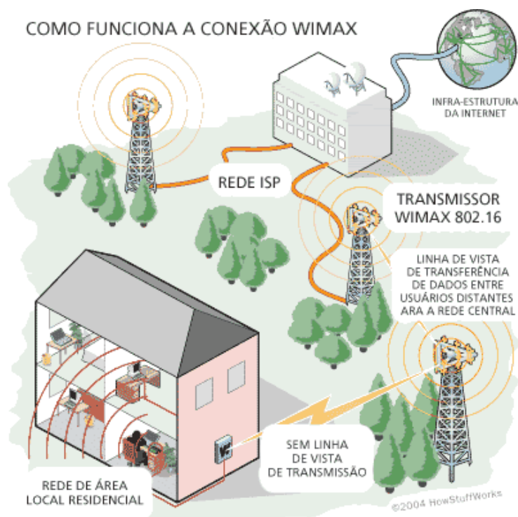
Figura 19 – Funcionamento da Conexão WiMAX (BRAIN; GRABIANOWSKI, 2012).
