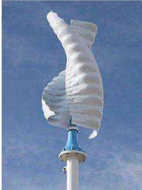
Figura 6. Turbina eólica de eixo vertical do tipo Savonius (fonte: http://www.archiexpo.com/ ).
