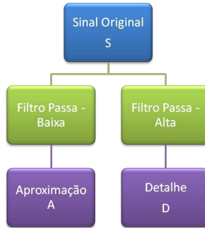
Figura 2.7: Ilustração para o processo de filtragem do sinal em aproximações e detalhes
