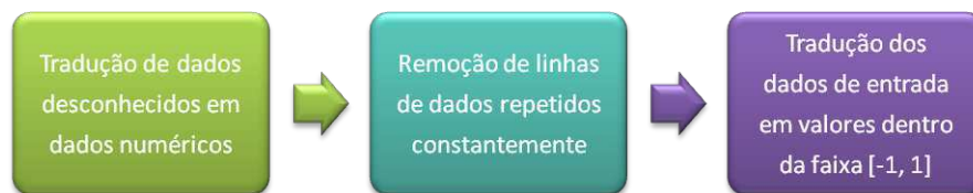
Figura 4.10: Diagrama de blocos para o processamento das entradas da rede
