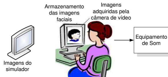
Figura 4.17: Ilustração da configuração da sala de monitoramento
