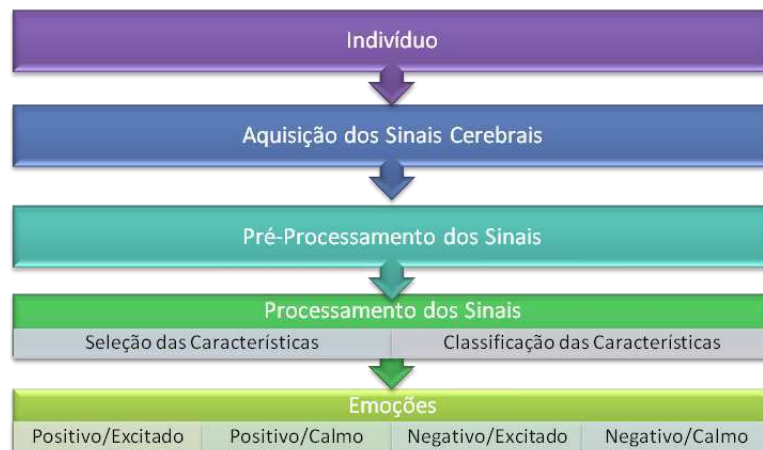
Figura 3.2: Diagrama de blocos para o módulo sinais cerebrais
