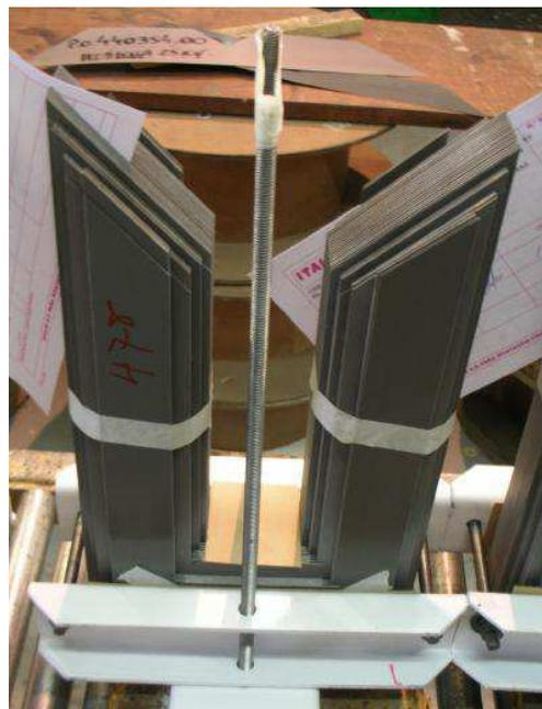
Figura 29 – Núcleo composto com lâminas de FeSi (NUNES, 2011).
