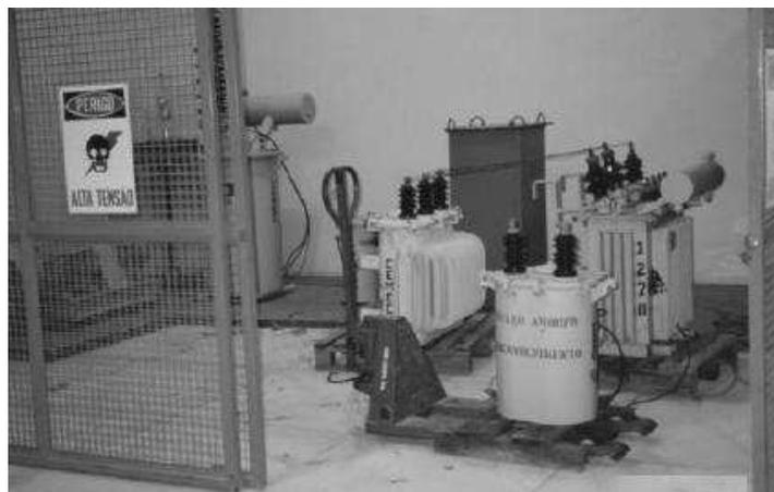
Figura 40 – Transformador monofásico de distribuição (núcleo de liga amorfa) de 15 kVA 13800 V / 220 V, classe 15 kV em ensaio no laboratório de Alta Tensão da CELB (CAVALCANTI; LUCIANO, 2001).
