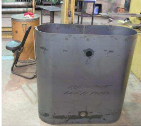
Figura 13 – Tanque do transformador pronto para ser soldada a parte inferior (NUNES, 2011).
