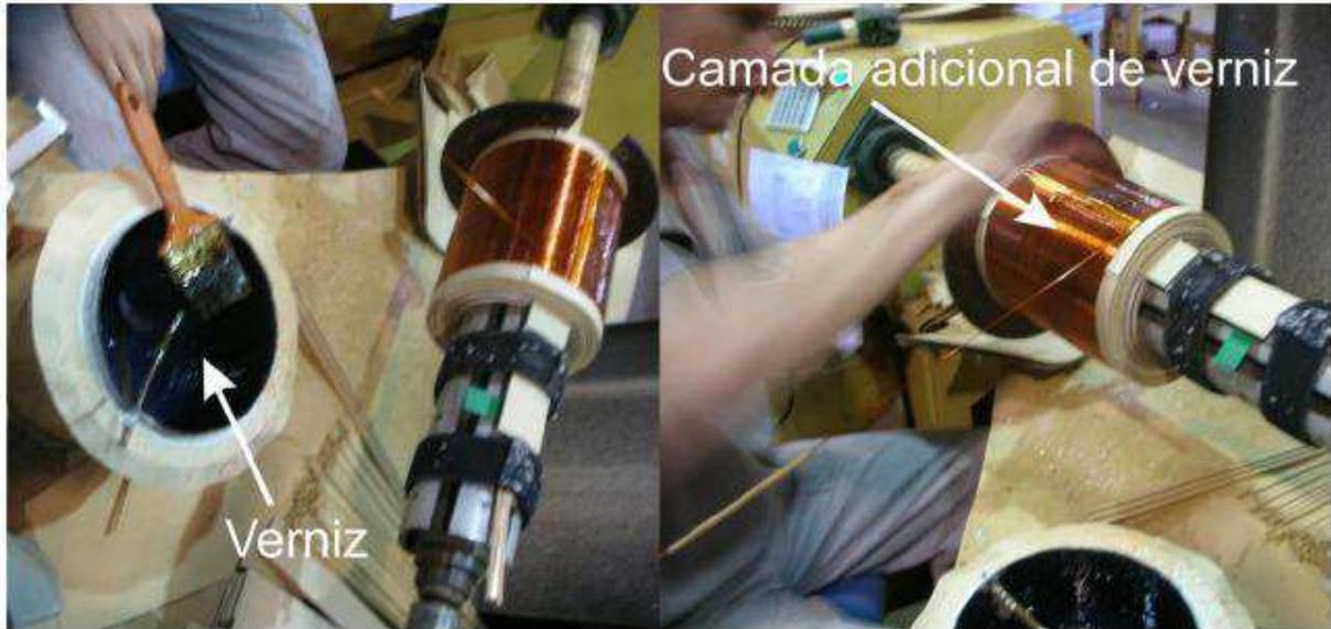
Figura 10 – Isolamento dos condutores AT (NUNES, 2011).
