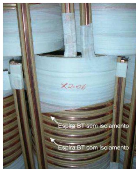
Figura 6 – Bobina de baixa tensão (BT) (NUNES, 2011).
