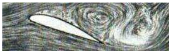
Figura 25. Fluxo separado (estol) em volta do perfil (CRESEB, 2013).
