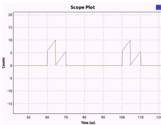
Figura 30 - Resultado da multiplicação de um sinal dente-de-serra e um pulso retangular dessincronizados.
