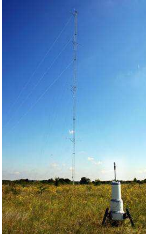
Figura 14 - Instrumentos usados para medição do vento e ambientais Mastro e Sodar Fonte - http://www.renewableenergyfocus.com
