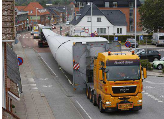
Figura 18 - Transporte da pá de turbina eólica modelo B75 da Siemens de 75m Fonte - http://www.siemens.com
