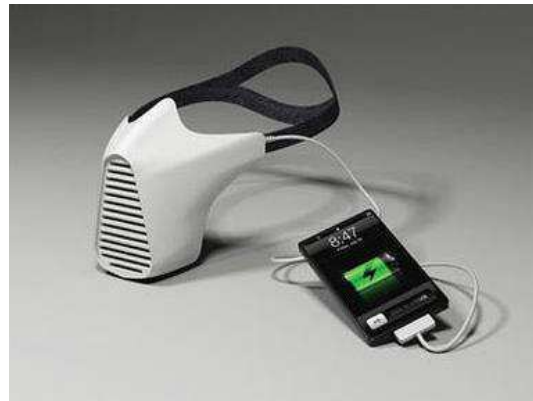
Figura 8 - Aire, protótipo que converte respiração em eletricidade Fonte: Super interessante
