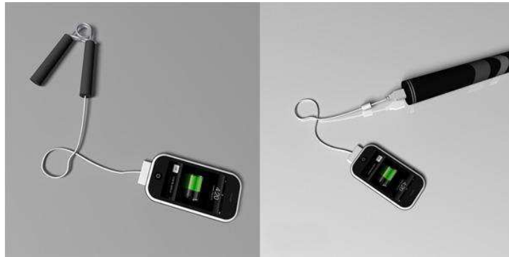
Figura 9 - Carregadores que transformam energia cinética em elétrica Fonte: Planeta Sustentável
