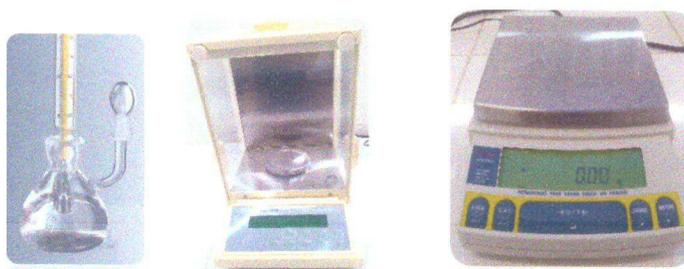
As densidades da polpa de graviola e da espuma foram determinadas por picnometria, utilizando-se picnômetros de 50mL previamente calibrados. Para o cálculo da densidade da polpa de graviola e da espuma empregou-se a seguinte equação:
