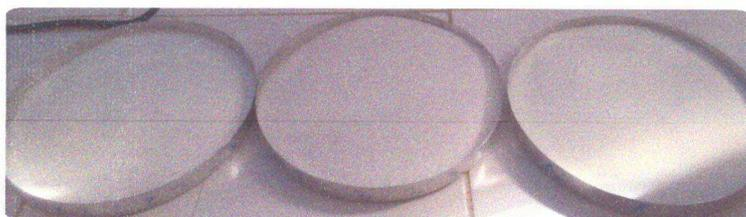
As formulações foram dispostas em bandejas de alumínio de formato circular e colocadas em estufa com circulação de ar.
