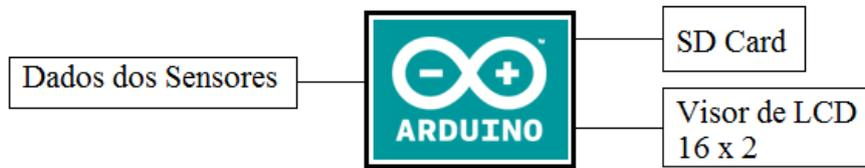
Figura 18 - Inerfce básica representada por um cartão de memória e um visor de LCD.
