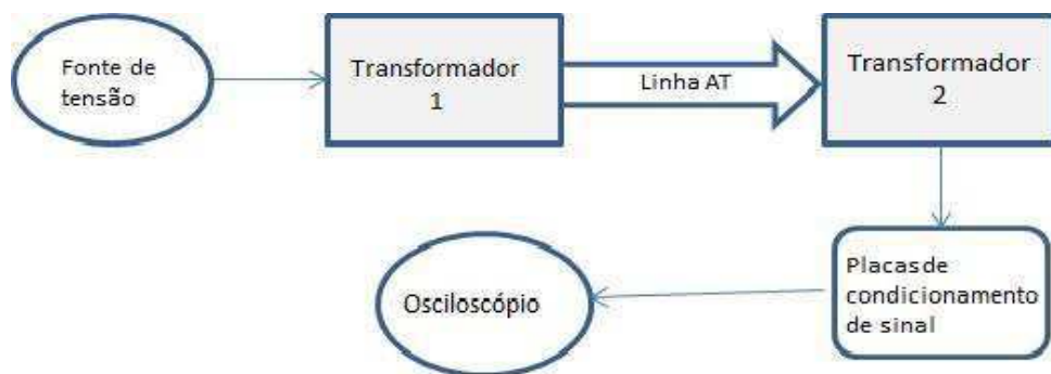
Figura 8 - Esquema de ligação para teste de placas de condicionamento de sinais.
