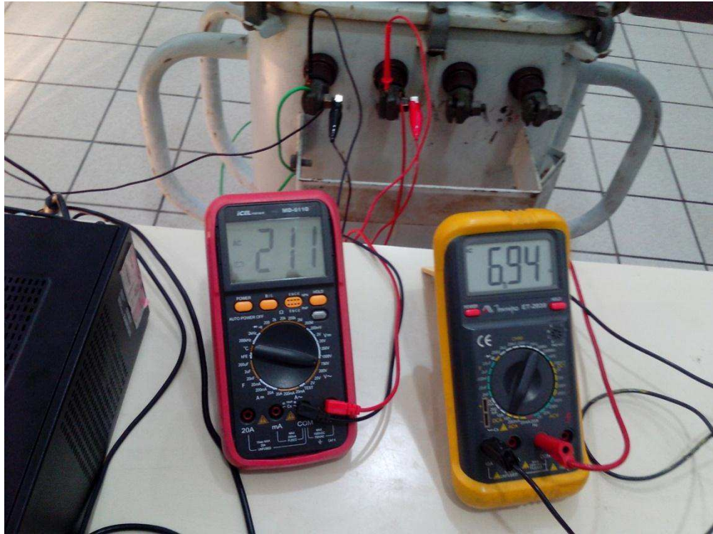
Figura 13 - fotografia da medição de tensão e corrente na carga
