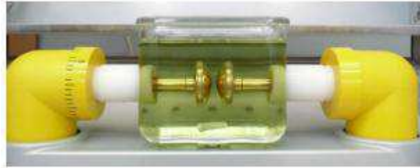
Figura 14: Célula de testes de rigidez dielétrica, DTA 100c da BAUR.
