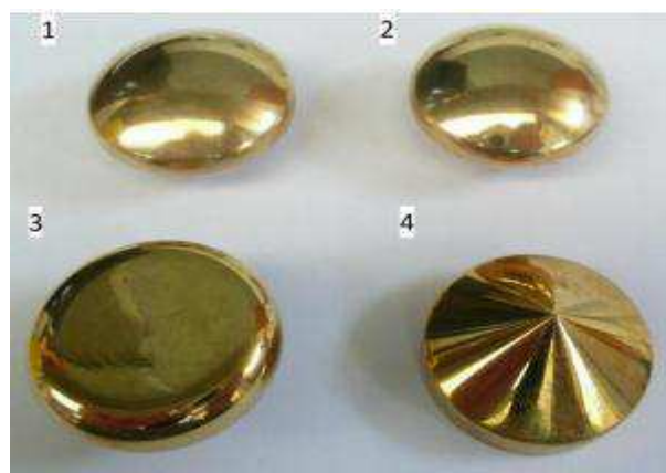
Figura 15: Configuração do eletrodo, (1,2) eletrodo tipo Rogowski, (3) eletrodo plano, (4) eletrodo ponto.
