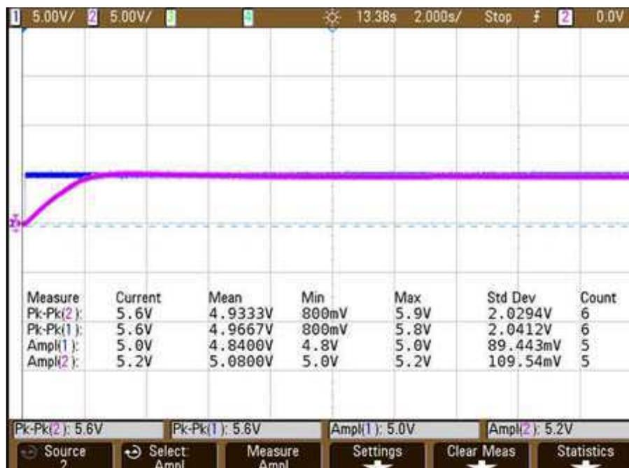
Figura 52. Resposta da saída obtida pela montagem do controlador PI com  $K_p = 10$ ,  $C_i = 22 \mu\text{F}$  e  $R_i = 10 \text{ k}\Omega$ .
