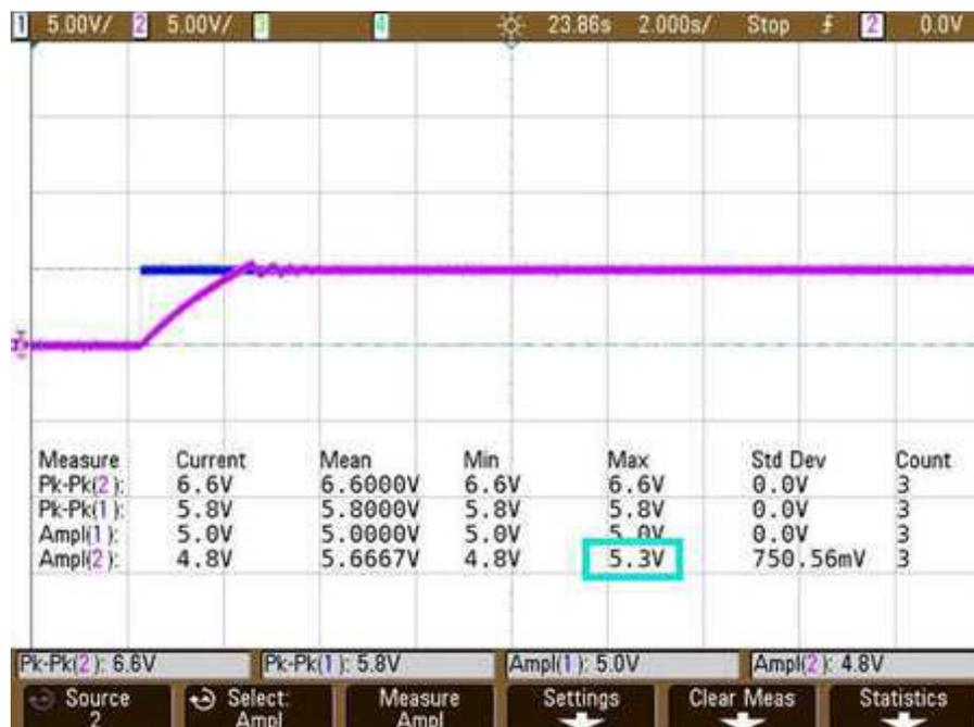
Figura 54. Resposta da saída obtida pela montagem do controlador PI com  $K_p = 5$ ,  $C_i = 2,2 \mu\text{F}$  e  $R_i = 10 \text{ k}\Omega$ .
