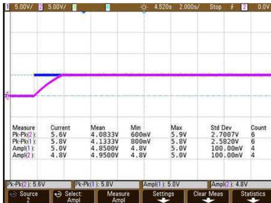
Figura 56. Resposta da saída obtida pela montagem do controlador PI com  $K_p = 5$ ,  $C_i = 0,22 \mu\text{F}$  e  $R_i = 10 \text{ k}\Omega$ .
