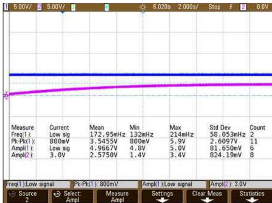
Figura 41. Resultado da montagem com o controlador P com  $K_p=50$ .
