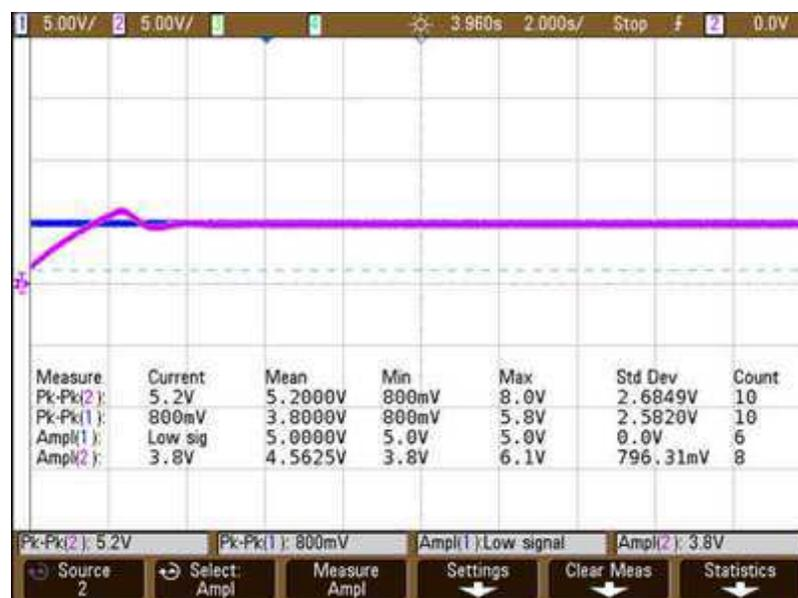
Figura 74. Resposta da saída obtida pela montagem do controlador PID com  $K_p = 5$ ,  $C_i = 2,2\mu\text{F}$ ,  $R_i = 50 \text{ k}\Omega$ ,  $C_d = 0,22\mu\text{F}$  e  $R_d = 500\text{k}\Omega$ .
