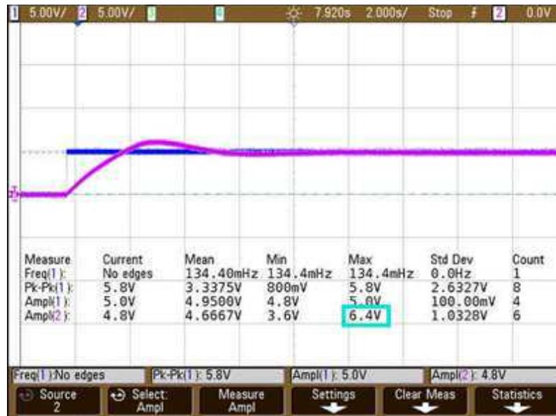
Figura 48. Resposta da saída obtida pela montagem do controlador PI com  $K_p = 1$ ,  $C_i = 22 \mu\text{F}$  e  $R_i = 10 \text{ k}\Omega$ .
