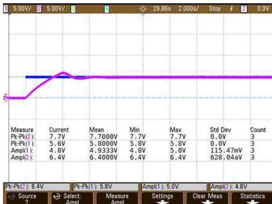
Figura 68. Resposta da saída obtida pela montagem do controlador PID com  $K_p = 5$ ,  $C_i = 2,2\mu\text{F}$ ,  $R_i = 50 \text{ k}\Omega$ ,  $C_d = 2,2\mu\text{F}$  e  $R_d = 300\text{k}\Omega$ .
