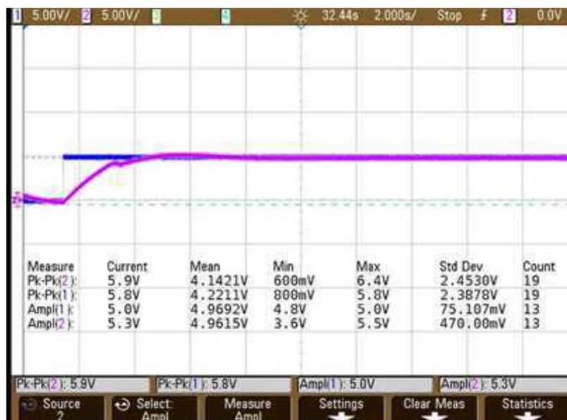
Figura 72. Resposta da saída obtida pela montagem do controlador PID com  $K_p = 5$ ,  $C_i = 2,2\mu\text{F}$ ,  $R_i = 50\text{ k}\Omega$ ,  $C_d = 22\mu\text{F}$  e  $R_d = 300\text{ k}\Omega$ .
