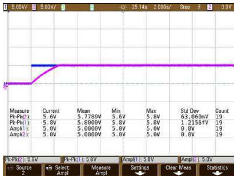
Figura 66. Resposta da saída obtida pela montagem do controlador PID com  $K_p = 5$ ,  $C_i = 2,2\mu\text{F}$ ,  $R_i = 50\text{ k}\Omega$ ,  $C_d = 2,2\mu\text{F}$  e  $R_d = 1\text{M}\Omega$ .
