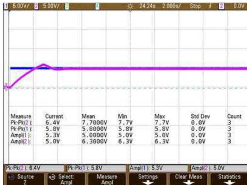
Figura 60. Resposta da saída obtida pela montagem do controlador PI com  $K_p = 5$ ,  $C_i = 2,2 \mu\text{F}$  e  $R_i = 100 \text{ k}\Omega$ .
