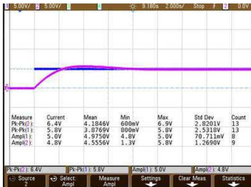
Figura 76. Resposta da saída obtida pela montagem do controlador PID com  $K_p = 5$ ,  $C_i = 22\mu\text{F}$ ,  $R_i = 50\text{k}\Omega$ ,  $C_d = 2,2\mu\text{F}$  e  $R_d = 500\text{k}\Omega$ .
