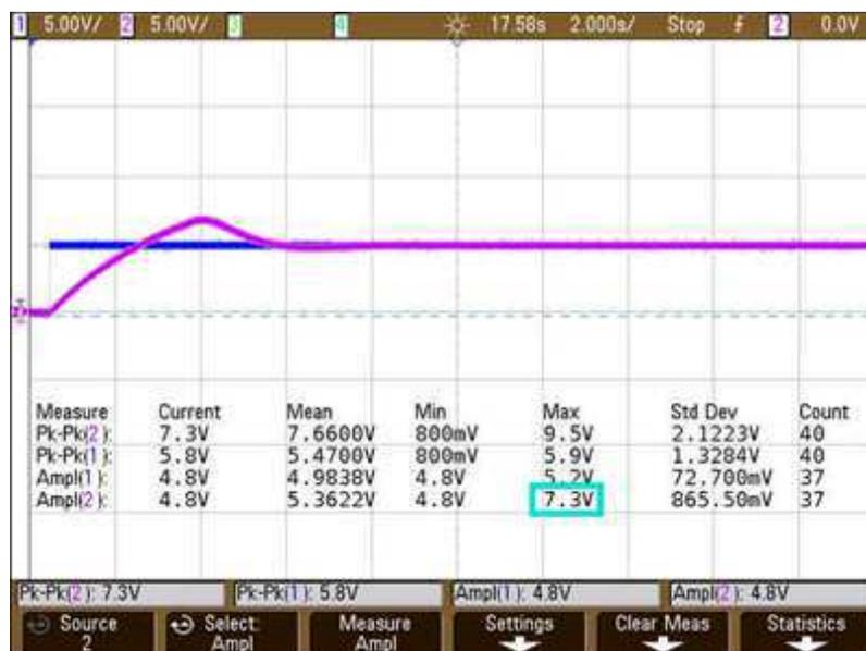
Figura 50. Resposta da saída obtida pela montagem do controlador PI com  $K_p = 5$ ,  $C_i = 22 \mu\text{F}$  e  $R_i = 10 \text{ k}\Omega$ .
