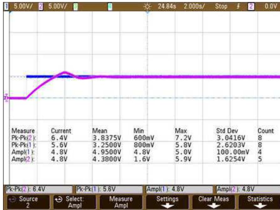
Figura 64. Resposta da saída obtida pela montagem do controlador PID com  $K_p = 5$ ,  $C_i = 2,2 \mu\text{F}$ ,  $R_i = 50 \text{ k}\Omega$ ,  $C_d = 2,2 \mu\text{F}$  e  $R_d = 500 \text{ k}\Omega$ .
