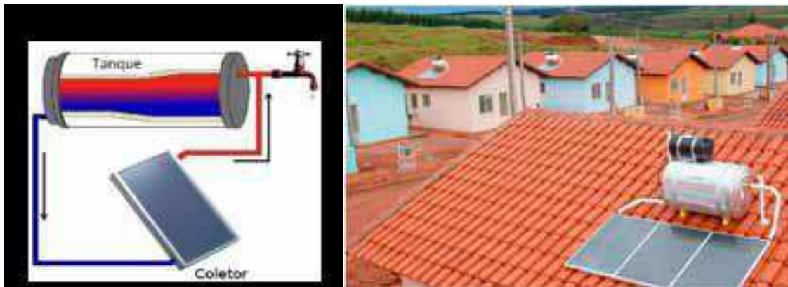
Figura 2.4 - –O aquecimento solar baseia-se na convecção natural da água(esq). Emprego de coletores planos num conjunto habitacional no Brasil (Dir).
