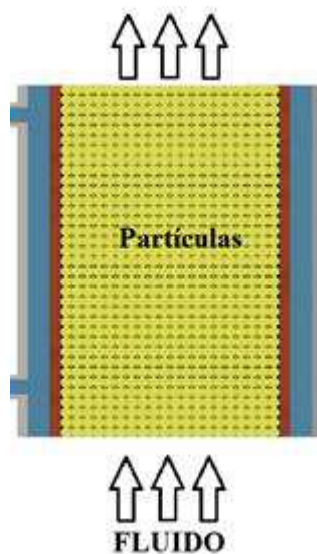
FIGURA 2.8 – Esquema de leito fixo ou coluna de recheio.
