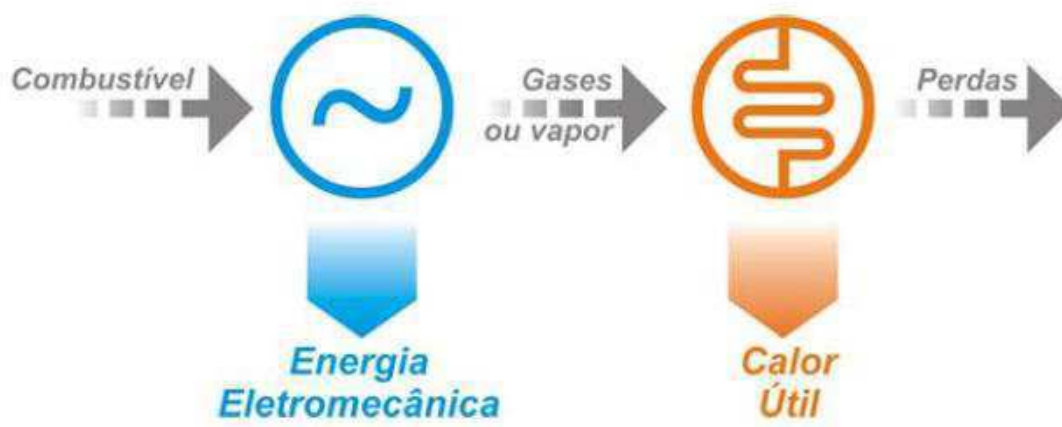
Figura 25 Esquema genérico de um Ciclo Topping (adaptado de (Carvalho, Nogueira e Teixeira, 2004)).
