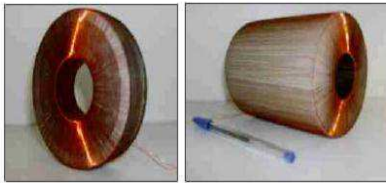
Figura 20. Bobinas de Rogowsky com núcleo de policarbonato à esquerda e à direita, com núcleo de nylon maciço [43].
