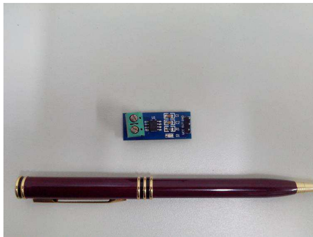
Figura 8. Placa do circuito do sensor de corrente ACS712 [4]
