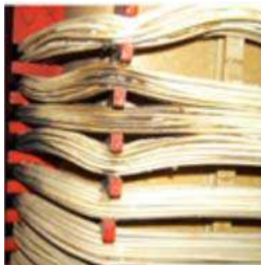
Figura 1. Dano causado pelas forças axiais [5].
