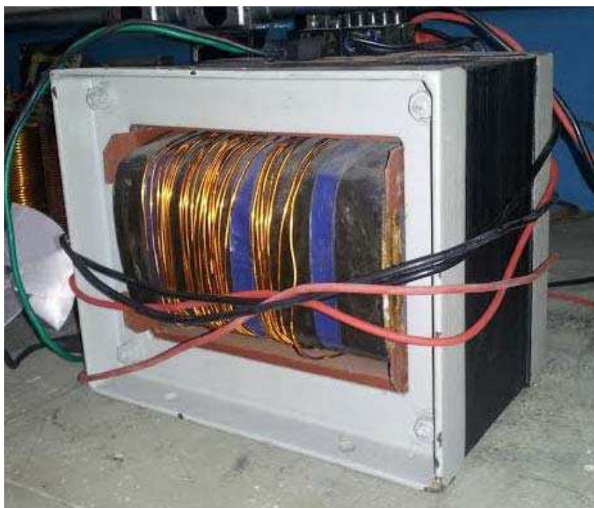
Figura 16. Transformador de 1 kVA.
