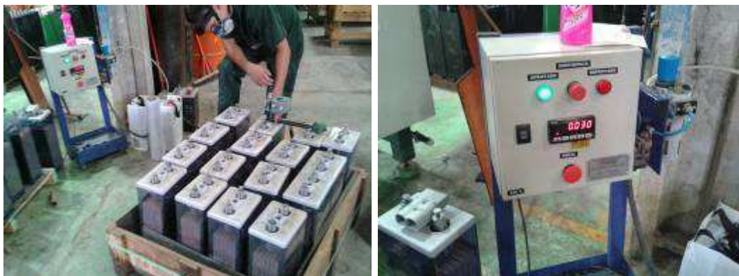
Figura 12- Teste de Vazamento.
