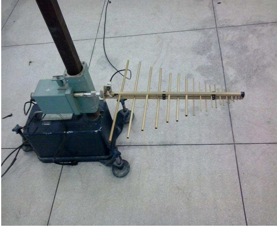
Figura 4.33 – Antena de referência acoplada ao conjunto móvel.
