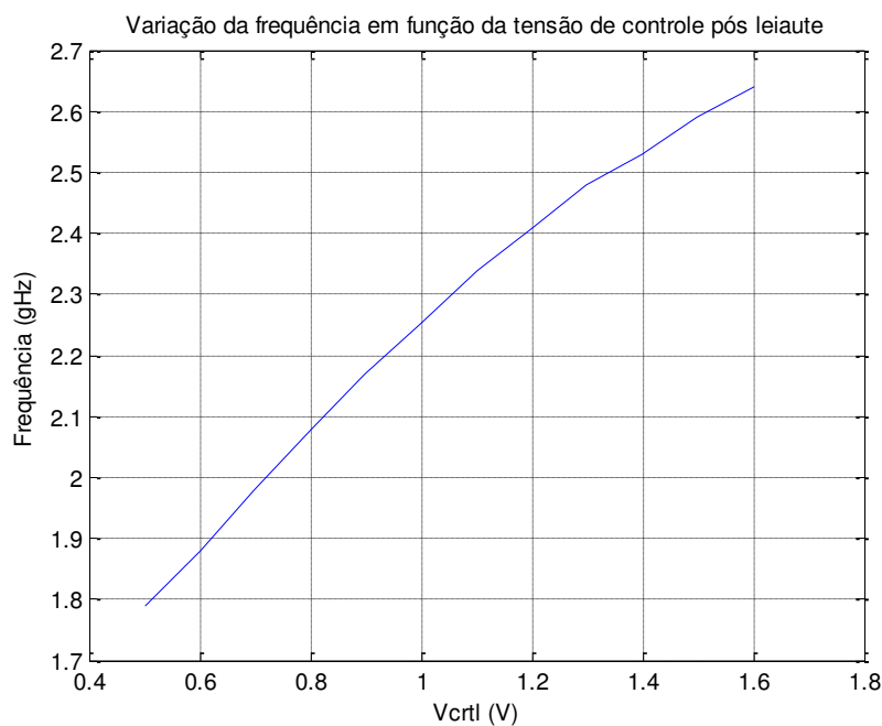
Figura 26 – Gráfico da variação de frequência em função da tensão de controle V_{ctrl} em nível de leiaute.
