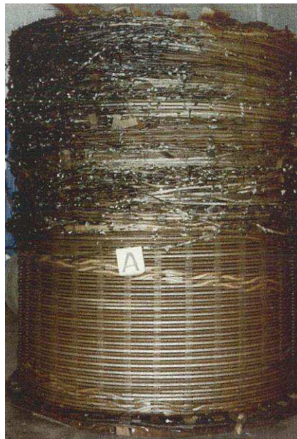
Figura 13 – Condutores inclinados que, com a perda da isolação, causaram um curto-circuito entre os condutores individuais e consequente destruição do enrolamento em um transformador GSU.
