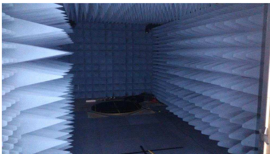
Figura 1 – Interior da câmara anecoica do LabMet-UFCG.
