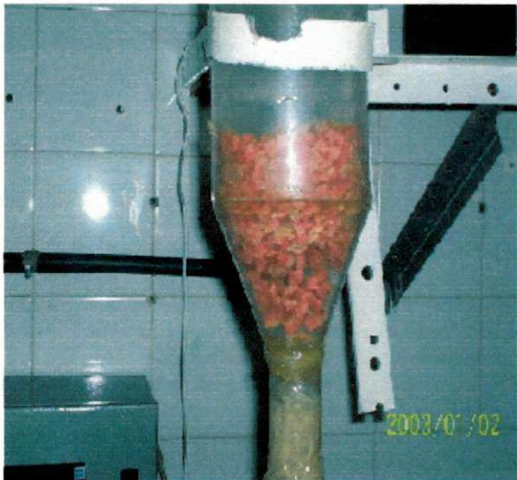
Figura 4.10 – Comportamento das partículas durante a secagem em leito fluidizado.
