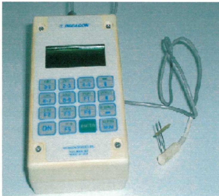
Figura 3.5 – Equipamento utilizado para determinação das propriedades térmicas (thermolink)
