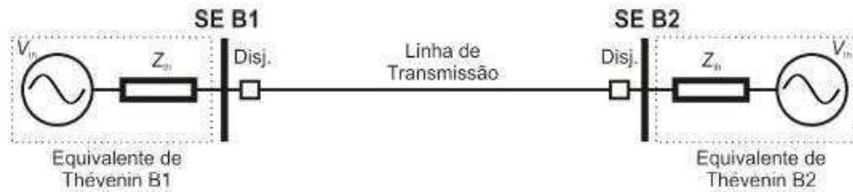
Figura 14 – Diagrama unifilar da linha de transmissão de 230 kV, LT FICT, entre as subestações SE B1 e SE B2.
