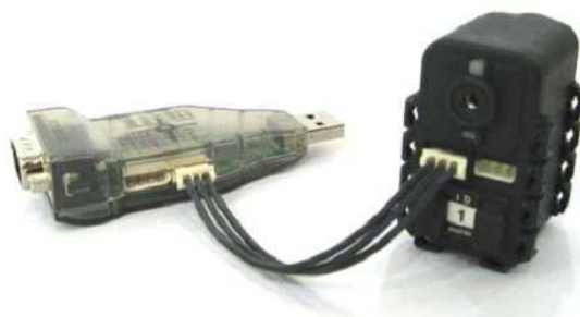
Figura 30 – Conexão entre o USB2Dynamixel e o AX-12A
