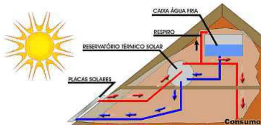
Figura 4 - Funcionamento do sistema solar térmico.
