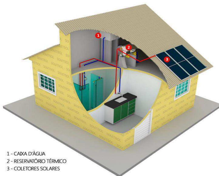
Figura 9 - Funcionamento do coletor solar comercial.
