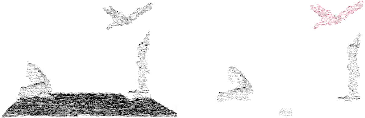
Figura 15 – Apresentação de alguns passos de pré-processamento: à esquerda, é apresentada a cena resultante após aplicação dos filtros pass-through , da remoção de ruído e da subamostragem; à direita, o resultado da posterior segmentação de plano e clusterização, onde o cluster correspondente à garra está destacado em vermelho.
