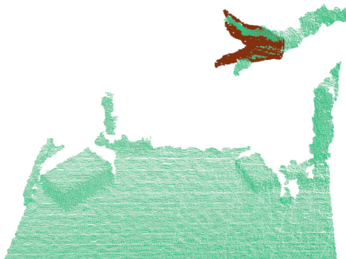
Figura 16 – Alinhamento Inicial para o modelo de garra aberta usando o algoritmo SAC-IA.
