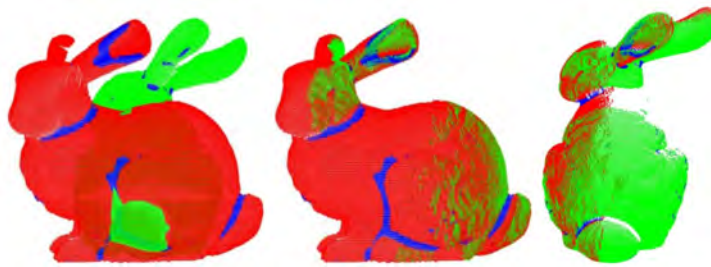
Figura 6 – Da esquerda para a direita: duas visões parciais do modelo de um coelho antes do alinhamento; resultados obtidos com a aplicação da solução encontrada pelo SAC-IA.
