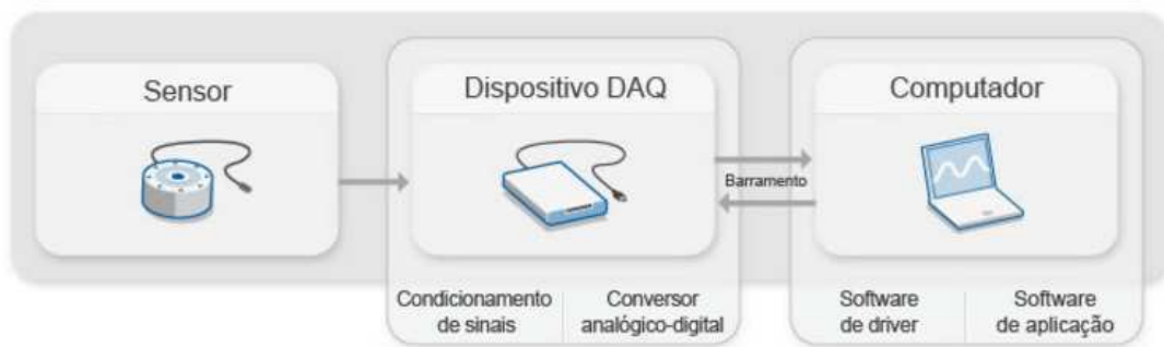
Figura 28 – Partes de um sistema DAQ.
